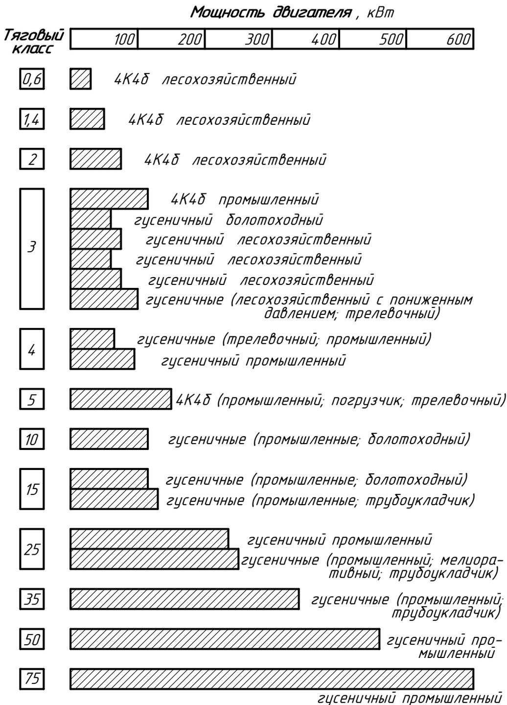
**Рис. 1.2. Типаж промышленных, лесопромышленных и лесохозяйственных тракторов**
